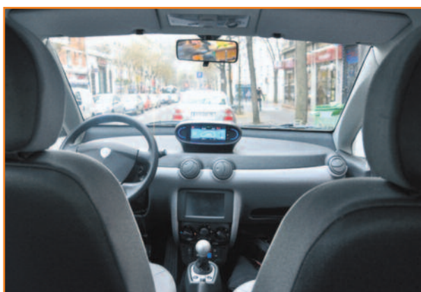
La Bluecars est équipée d'un ordinateur de bord et d'un GPS.
