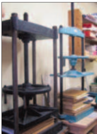
Les "presses" sont ces machines dans lesquelles reposent les livres plusieurs heures après chaque étape de la reliure.
