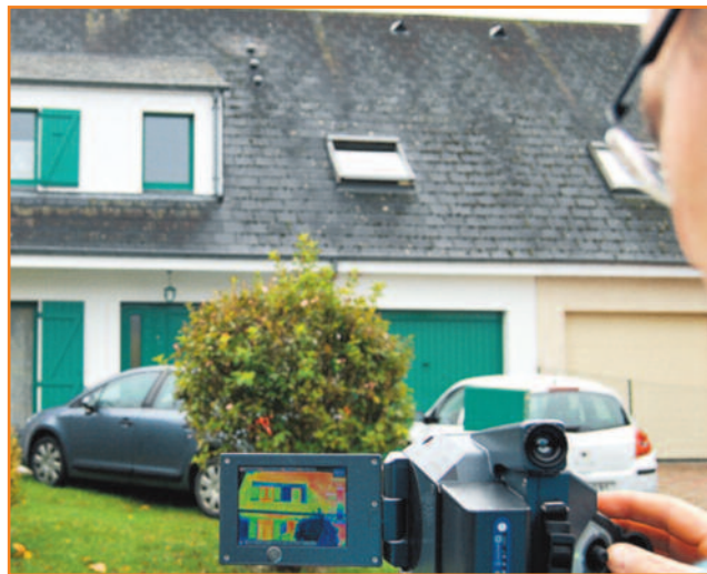
Dominique Roperch utilise la technologie de la thermographie infrarouge pour détecter les déperditions de chaleur des bâtiments.
